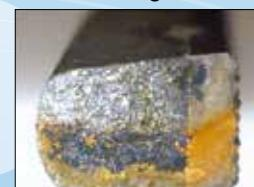
Langtidsopbevaring kan også forårsage rust som følge af opbevaringsforholdene. Det er ikke kun korrekt rengøring og tørring, som er påkrævet. Det er smøring af samlingsdele også. Disse processer kan forebygge rust og sørge for, at instrumenterne bevæger sig jævnt. Desuden skal en skralde låses op og samlinger åbnes under sterilisering.
