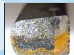
Uzun süreli depolama da saklama koşullarına bağlı olarak paslanmaya neden olabilir. Temizlik ve kurutmanın düzgün şekilde yapılmasının yanı sıra eklemleri parçaların yağılanması da gereklidir. Bu işlemler paslanmayı önleyebilir ve aletlerin sorunsuz şekilde hareket etmesini sağlar. Lütfen sterilizasyon sırasında mandalın kılıdını ve eklemleri parçayı açın.
