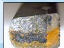
Un stockage à long terme peut aussi entraîner la formation de rouille selon les conditions de stockage. Il est non seulement nécessaire de nettoyer et de sécher les pièces articulées de façon adéquate, mais aussi de les lubrifier. Ces processus protègent les instruments contre la rouille et allongent leur durée de vie. Pensez aussi à ôter un cliquet et à ouvrir une articulation lors de la stérilisation.
