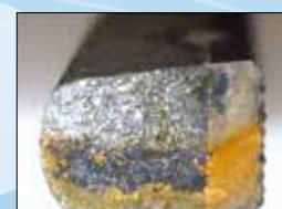
Langdurige opslag kan ook de oorzaak zijn van roest als gevolg van de opslagomstandigheden. Het is niet alleen nodig om goed te reinigen en te drogen, maar ook om een scharnierdeel te oliën. Deze processen kunnen roest voorkomen en ervoor zorgen dat instrumenten soepel blijven werken. Ontgrendel een ratel en open een scharnierdeel tijdens sterilisatie.
