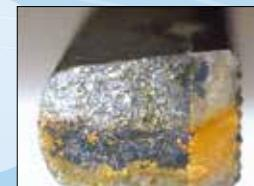
Anche la conservazione prolungata degli strumenti può essere causa di formazione di ruggine in determinate condizioni. Non solo è necessario effettuare correttamente pulizia ed asciugatura, ma anche la lubrificazione delle cerniere. Ciò potrà evitare la formazione della ruggine ed i conseguenti inceppamenti. Si consiglia inoltre di sbloccare e tenere aperte le cerniere durante la sterilizzazione.
