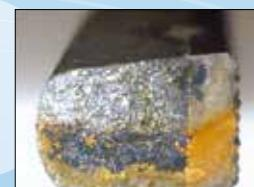
Długotrwałe przechowywanie może być również przyczyną powstawania rdzy ze względu na warunki przechowywania. Wymagane jest nie tylko prawidłowe czyszczenie i suszenie, ale także naoliwienie części przegubowej. Procesy te mogą zapobiegać rdzewieniu i zapewniać płynne działanie instrumentów. Podczas sterylizacji odblokować zapadkę i otworzyć część przegubową.
