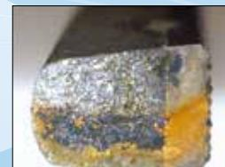
Los almacenamientos prolongados también pueden ser la causa de la oxidación debido a las condiciones en que se produzcan. No solo es preciso limpiar y secar adecuadamente, sino también engrasar las piezas articuladas. Estos procesos pueden evitar la oxidación y ayudan a que los instrumentos funcionen con suavidad. Durante la esterilización, no olvide desbloquear los trinquetes y abrir las piezas articuladas.
